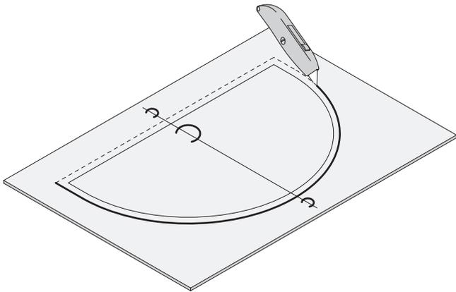
Recorte la plantilla de la ventana por la línea de desplazamiento de la abertura no acabada.
