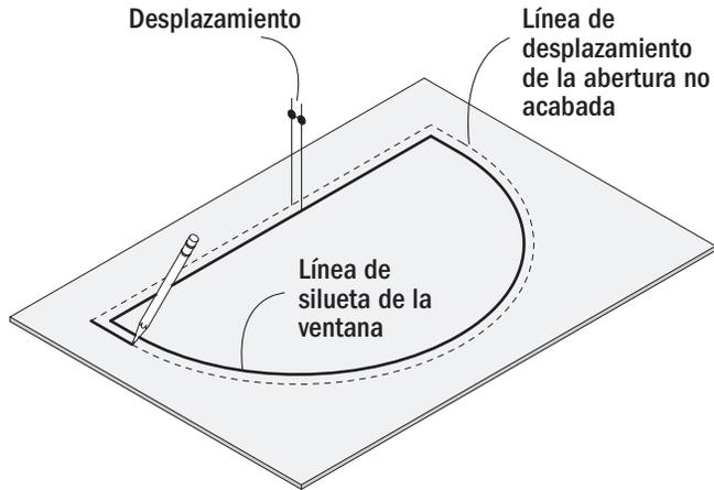
Dibuje una línea de desplazamiento de la abertura no acabada alrededor de la silueta de la ventana. La dimensión del desplazamiento es específica para la serie de cada ventana.
