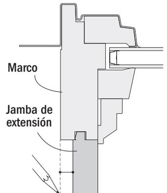
Para las ventanas con jambas de extensión aplicadas, ajuste la línea de la plantilla para compensar el desplazamiento entre el perímetro exterior de la jamba de extensión y el perímetro exterior del marco.
